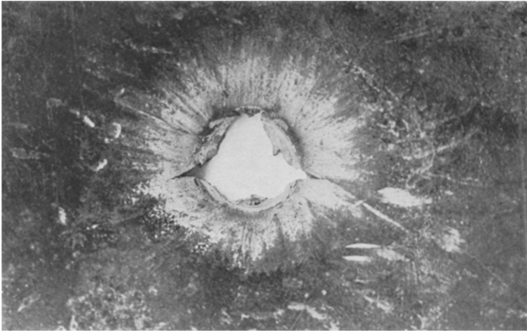
Abb. 35. Wirkung eines Geschößes der Patrone .44 Magn. ( v_a \sim 450 m/sec) auf 4 mm starkes Stahlblech (Durchschlag!). Um die Schußöffnung herum starke Auflagerungen von geschmolzenem Blei als Ausdruck der hohen v_a
