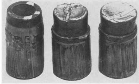
Abb. 32. Wirkung von Lamettfadens auf den Geschoßkopf. Links: TM-Hohlspitz-Geschoß ( v_a = 176 m/sec); Mitte: TM-Flachkopf-Geschoß ( v_a = 380 m/sec), danach noch durch 1 cm Gelatine; rechts: TM-Flachkopf-Geschoß ( v_a = 380 m/sec), danach noch durch 3 cm Gelatine. Beachte die ungleich größere Wirkung des Lamettfadens bei höherer v_a
