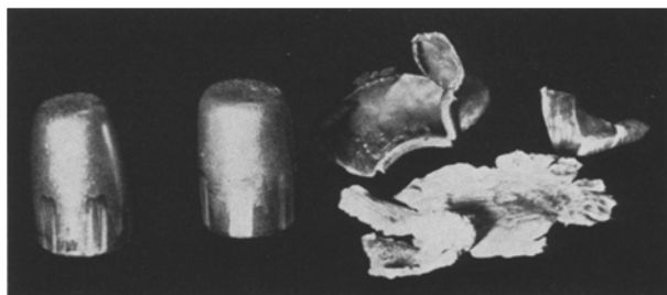
Abb. 38. Senkrechter Schuß auf einen Stahlblock mit 9 mm-Parabellum-Geschossen verschiedener v_a . Von links nach rechts: v_a = 70, 100 und 250 m/sec. Das Para-Geschoß der Original-Patrone ( v_a = 350 m/sec) hatte sich in so feine Teile zerlegt, daß sie zum größten Teil nicht mehr gefunden wurden
