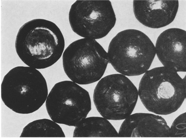
Abb. 31. „Natürliche“ Deformation der Schrotkörner durch Zusammenpressung im Lauf (bzw. Patronenlager) infolge der starken Beschleunigung. Aus [20]
